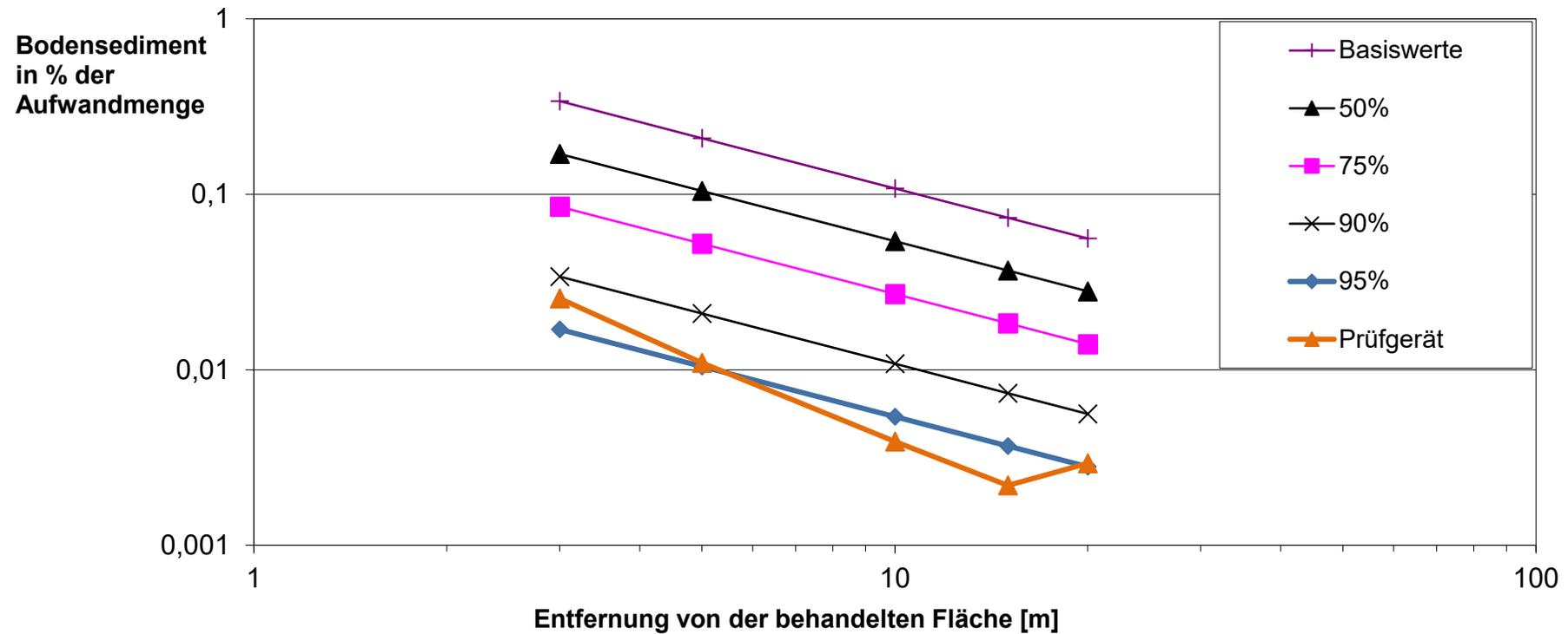
Die Einstufung des Prüfgerätes erfolgt in die Klasse, deren Grenzwerte lt. Anlage 1, im gesamten gemessenen Bereich oberhalb der Mediane der Messwerte für das Prüfgerät liegen (hier 90 %).
