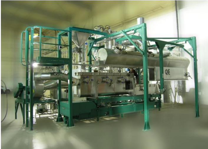
ThermoSeed-Anlage in Bjuv (Schweden) Kapazität 100-200 kg/h
