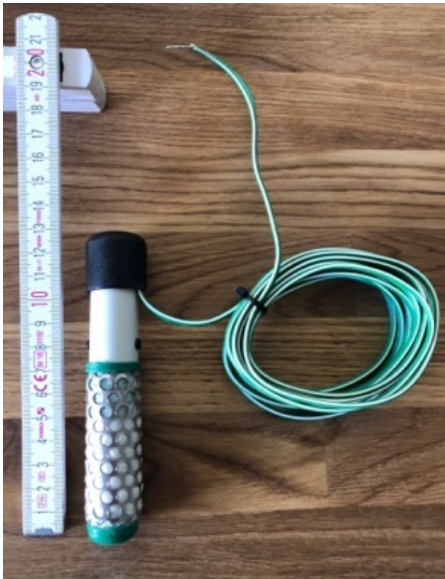
Watermark – Sensor: Messung der Wasserspannung (0 bis 252 kPa/cbar, pF-Wert: 0 bis 3,4)
