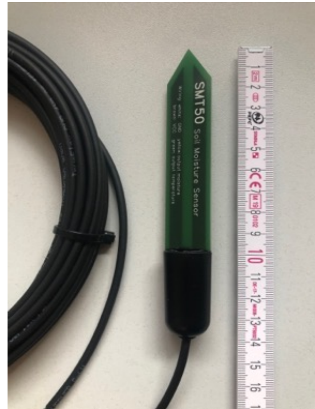
SMT50 – Sensor: Messung des volumetrischen Wassergehaltes (0 bis 50 Vol.-%)
