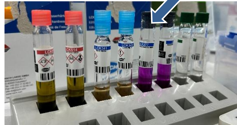
Analyse des Grauwassers auf CSB, Nitrit und Wasserhärte.
