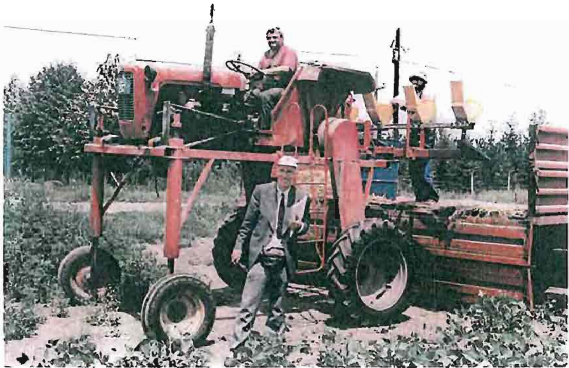
Abb. 3: Hochstelzenschlepper als Träger einer Verteilerplattform zum Ausstreuen MCA-beladenen Maiskolbenschrots zwecks Verwirrung von WCR bei Kula, Serbien, 2001.
