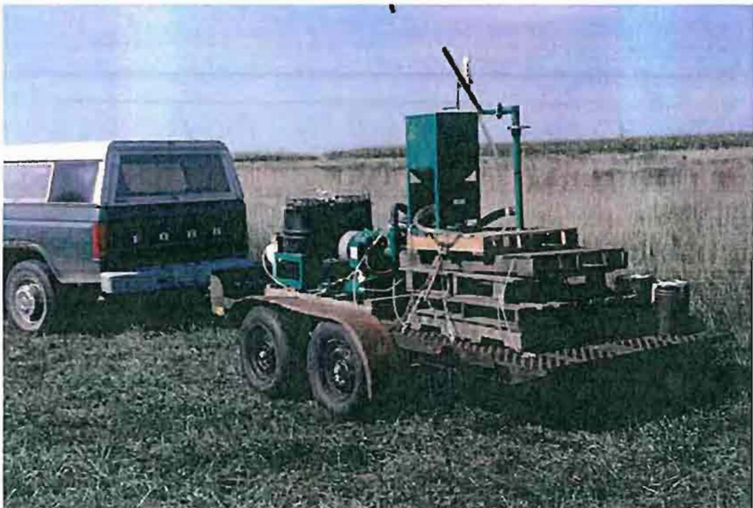
Abb. 4: Arro-Gun® montiert auf Anhänger zum Verblasen von MCA beladenem Maiskolbenschrot zwecks Verwirrung von WCR in Champaign, Illinois, Aug 1998 (NOVAK et al. 2001)
