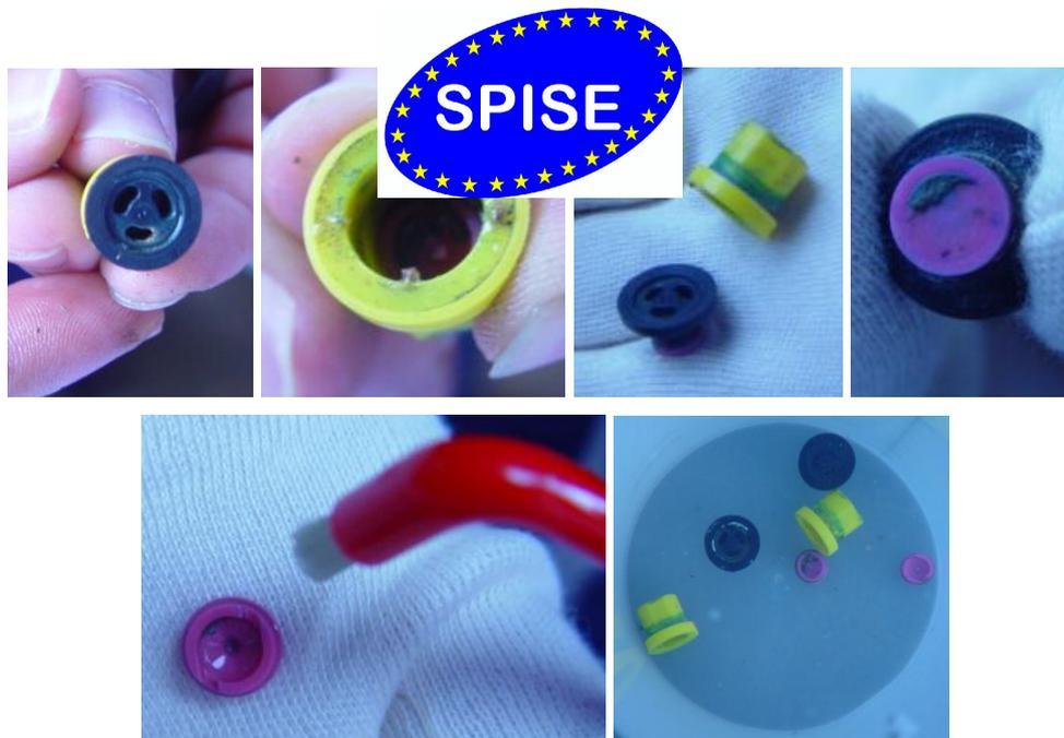
Fig. 19 – Desmontagem e limpeza dos componentes do bico
