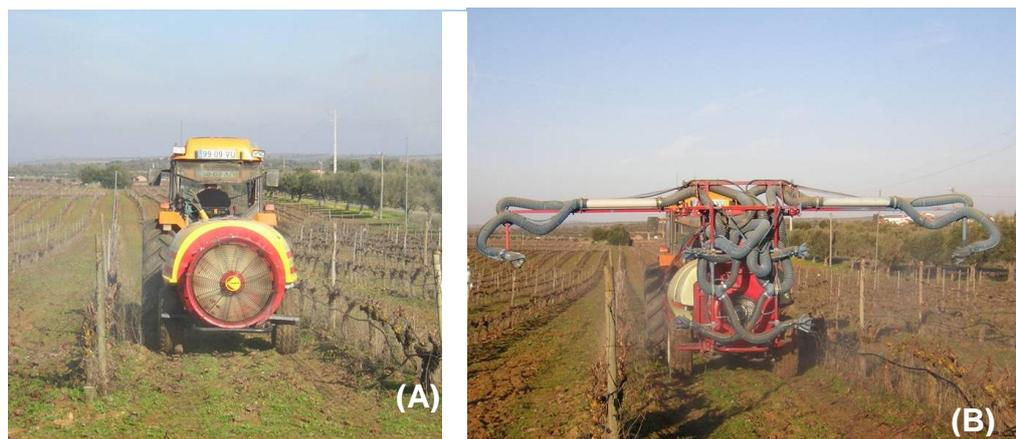
Fig. 14 – Pulverizador de pressão hidráulica assistido por ar (“turbina”) (A) e pulverizador pneumático (B) na cultura da vinha.
