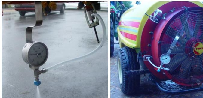
Fig. 21 - Medição da pressão no bico de pulverização
