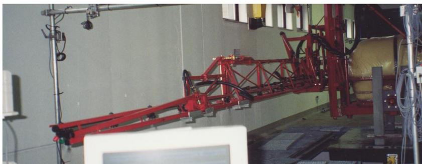
Fig. 4 – Simulador do movimento da barra de pulverizador durante a aplicação em cereais
