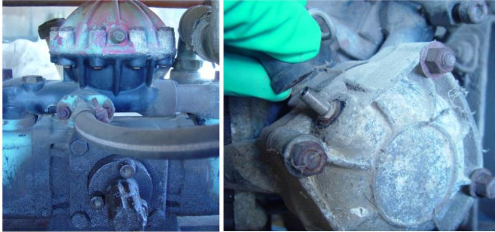
Fig. 22 – Tanques de oscilação em diferentes tipos de bombas
