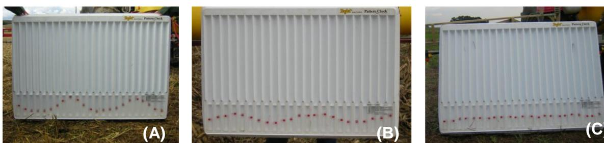
Fig. 6 – Distribuição de calda: efeito da distribuição com a barra muito próxima do solo (A) e à adequada distância ao solo (C); em (B) é visível o resultado da pulverização, com a barra entre a altura inadequada (A) e a correcta (C).
