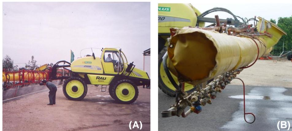
Fig. 13 – Pulverizador de pressão hidráulica, com propulsão própria (A), equipado com barra assistida por ar (B)
