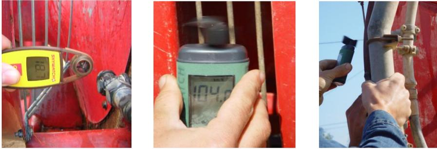
Fig. 8 – Medição da velocidade do ar em diferentes pontos no contorno do ventilador
