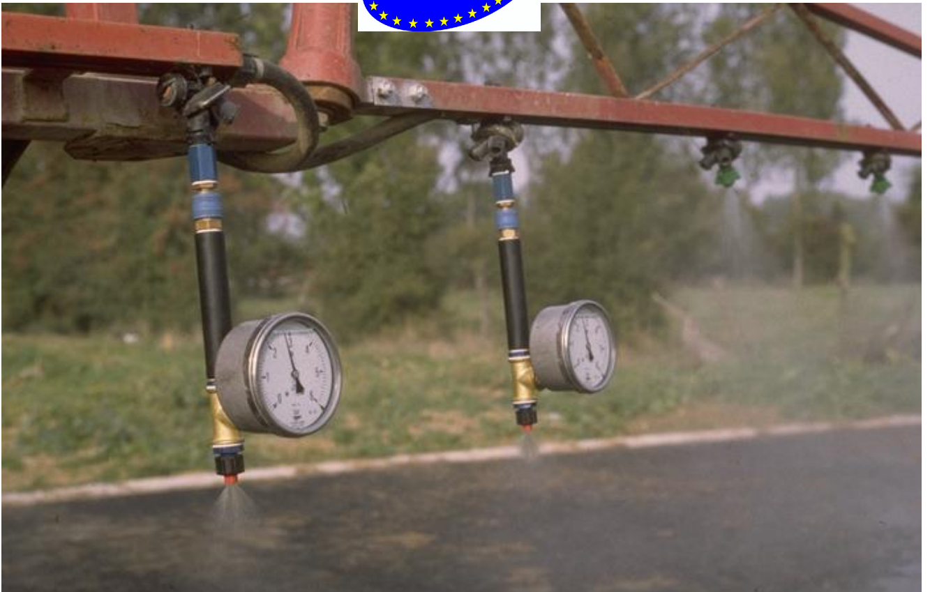
Photo 2 : manomètres étalons positionnés sur la rampe en lieu et place d'une buse.
