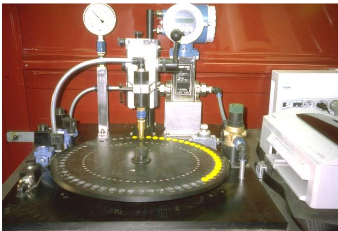
Photo 4 : banc de contrôle du débit des buses.
