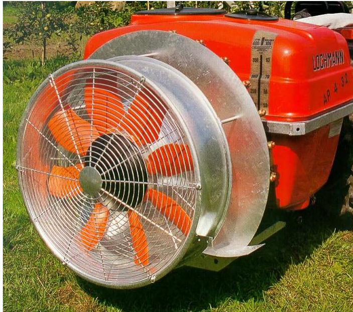
Flusso d'aria parallelo all'asse di rotazione sia in ingresso che in uscita
