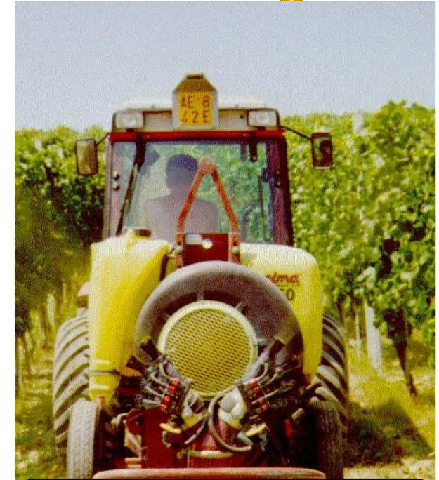
Flusso d'aria parallelo all'asse di rotazione in ingresso e perpendicolare all'asse in uscita
