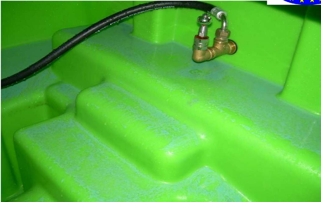
***Esempi di impianti di lavaggio montati all'interno dei serbatoi della macchina irroratrice***
