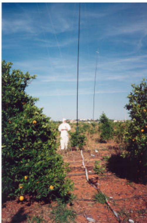
**Fig. 1.26** – Ensaio em pomar de citrinos, para estudo do arrastamento da calda e da contaminação dos indivíduos presentes nas imediações da aplicação (note-se o papel de filtro no solo e as linhas suspensas fixadas em mastro)
