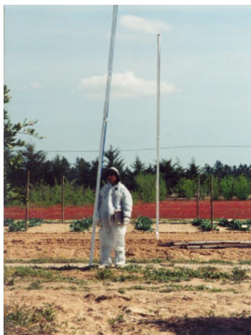
**Fig. 1.27** – Pulverização com pistola (A) em pomar de citrinos para estudo da exposição do operador, do arrastamento de calda e da contaminação do voluntário estacionário à distância de 5 metros (B) da zona pulverizada
