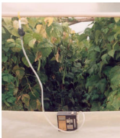
**Fig. 1.8** – Filtro de amostragem para estudo da exposição por inalação potencial colocado na janela da estufa
