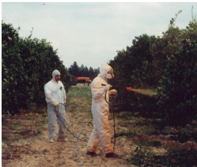
**Fig. 1.24** – Ensaio com corantes para avaliação da exposição do operador e do ajudante do operador na pulverização, com pistola, em pomar de citrinos
