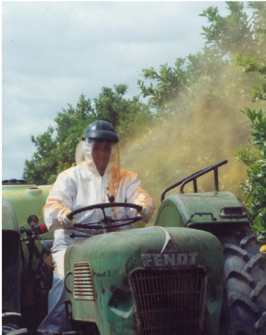
**Fig. 1.19** – Aplicação com pulverizador de pressão hidráulica, suspenso no tractor
