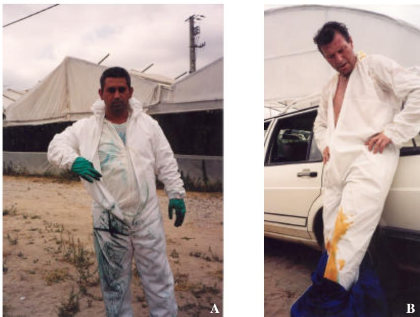
**Fig. 2.2** – Ensaio de campo de EPI no Patacão. Efeito da penetração do corante azulado (A) e do alaranjado (B), através dos fatos estudados
