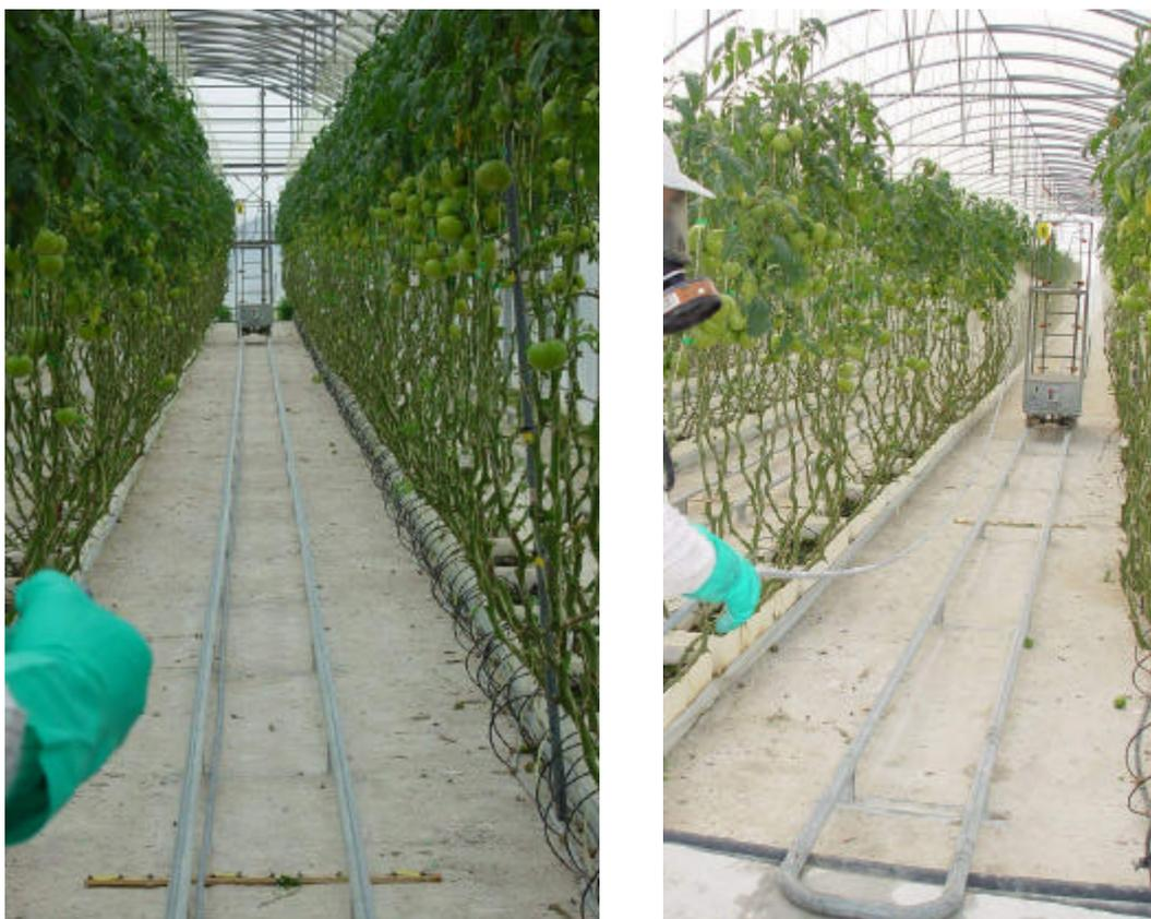
**Fig. 1.23** – Equipamento de aplicação de produtos fitofarmacêuticos em carris na entrelinha, com accionamento por dispositivo de comando remoto, nas estufas da empresa Carmo & Silvério (A-dos-Cunhados), em 2002. À direita, enrolamento da tubagem em equipamento de aplicação instalado em carris na entrelinha
