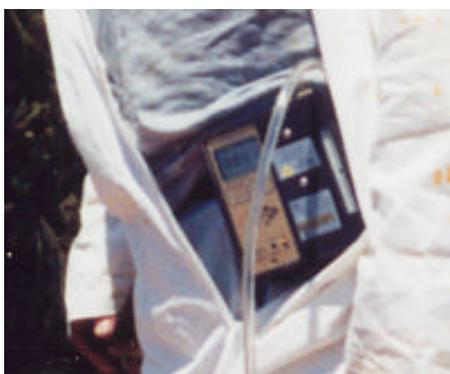
**Fig. 1.10** – Bomba de amostragem para medição da contaminação por inalação potencial
