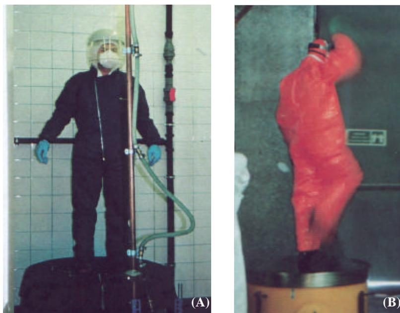
**Fig. 2.1** – Dispositivo com tmbola giratria para os estudos de permeabilidade de EPI, nos laboratrios do CSL (A) do INSHT (B)
