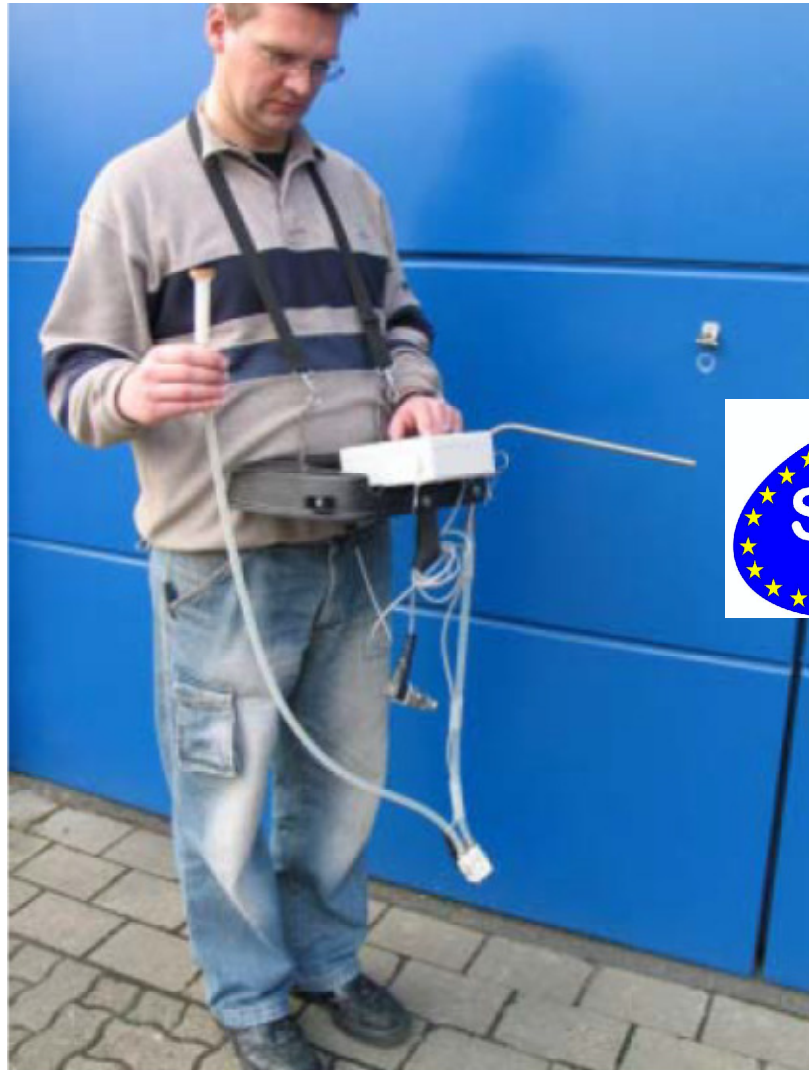
Düsendurchflußmessgerät Herbst FHK 3.30
