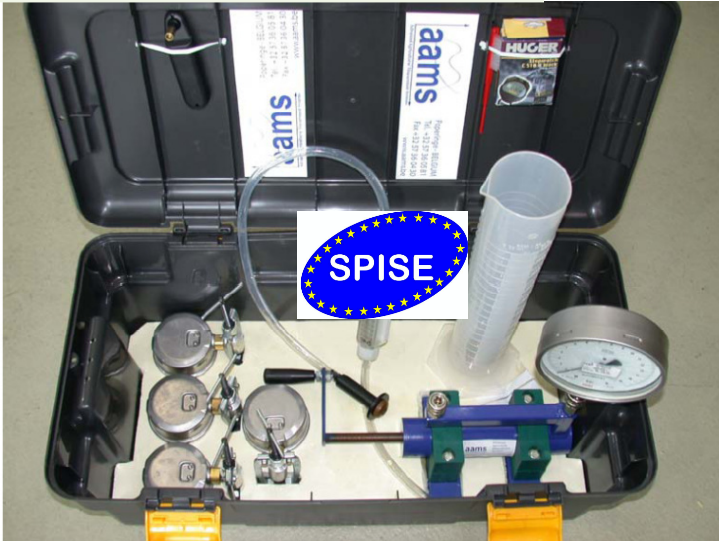
AAMS Typ „TBS“ (Manometerkontrolle bis 16 bar)
