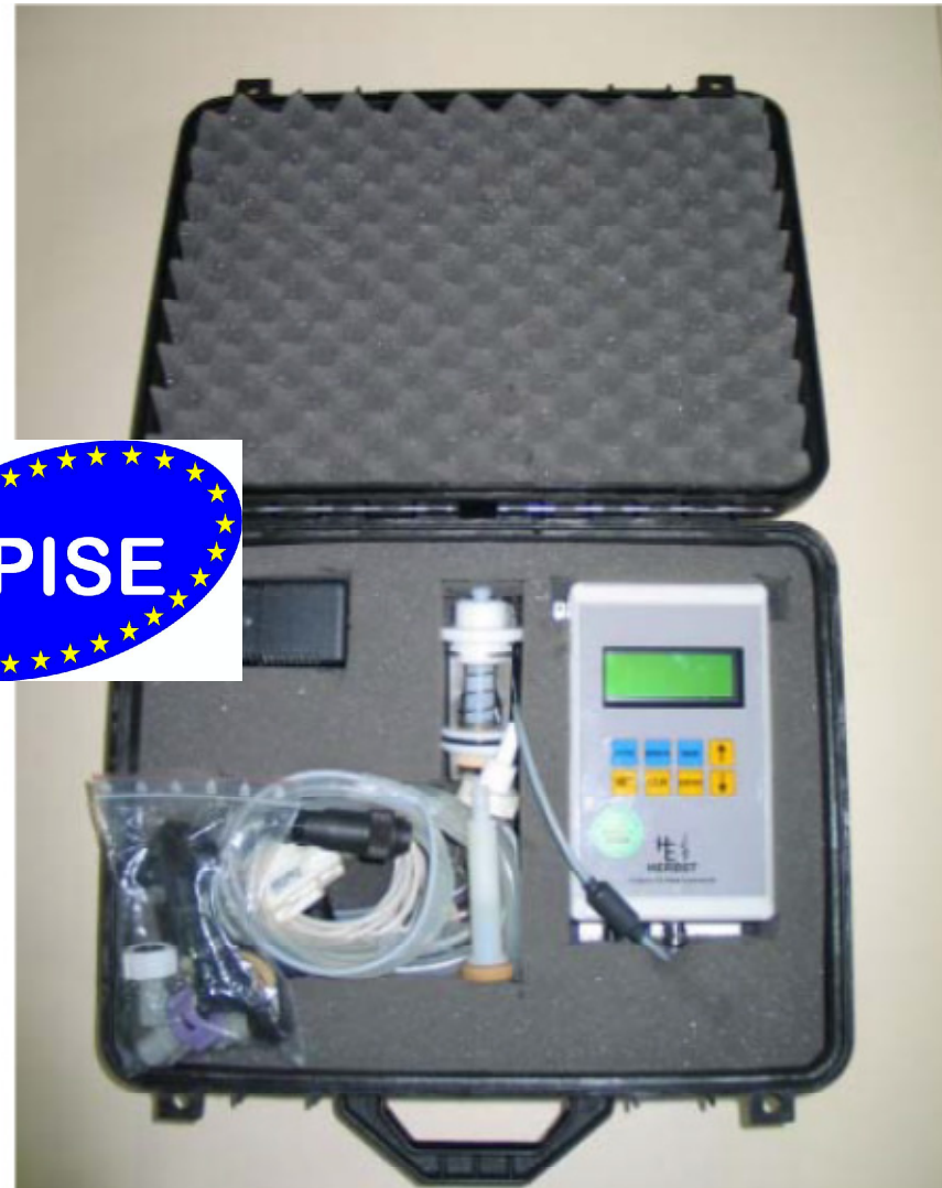
Düsendurchflußmessgerät Herbst FHK 3.30
