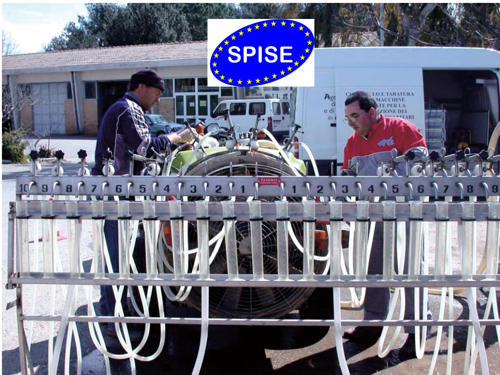
Fig. 14 – Verifica della portata degli ugelli di una irroratrice per colture arboree (foto A. Caponero – SEDI – ALSIA Basilicata).
