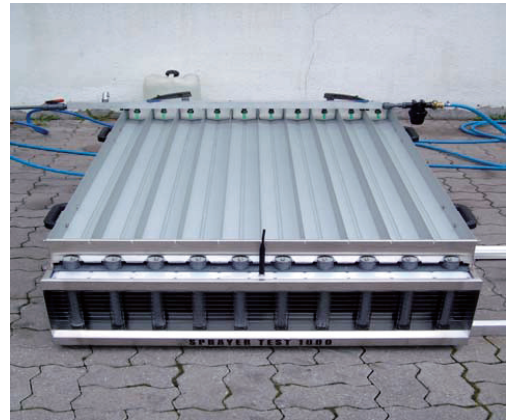
Fig. 4 - Particolare di un banco prova tipo "scanner" per la determinazione del diagramma di distribuzione delle barre irroratrici (foto D. Ghigo - DEIAFA)
