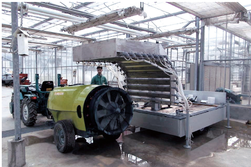
Fig. 17 - Determinazione del diagramma di distribuzione di una irroratrice utilizzata per il trattamento alla vite allevata a Tendone (foto D. Civitella Co.T.Ir - ARSSA Abruzzo)
