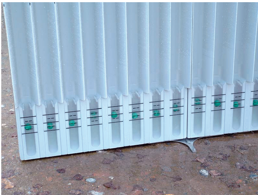
Fig. 19 – Particolare dei galleggianti che evidenziano il diagramma di distribuzione ottenuto da una prova con una irroratrice a barra (foto C. Cossaro - DEIAFA)
