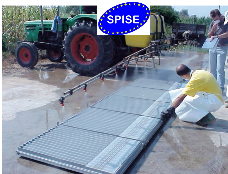
Fig. 18 - Determinazione del diagramma di distribuzione di una barra irroratrice mediante banco a canalette (foto G. Oggero - DEIAFA)
