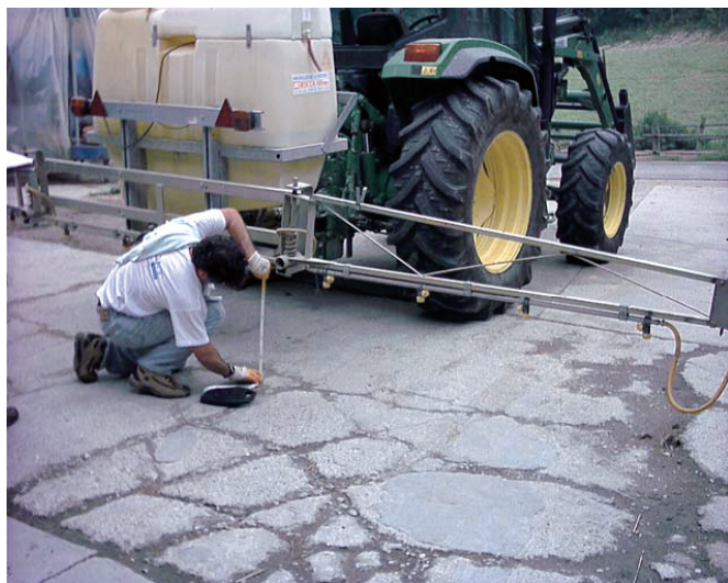
Fig. 11 – Verifica del corretto assetto della barra (foto G. Oggero – DEIAFA)
