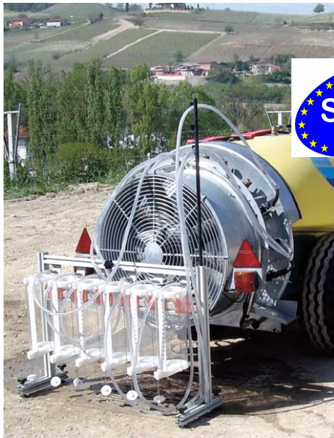
Fig. 5 - Esempio di banco per la determinazione della portata degli ugelli di una irroratrice per colture arboree (foto G. Oggero - DEIAFA).
