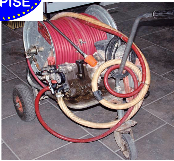
Fig. 20 - Esempi di differenti tipologie di lancia utilizzata soprattutto per trattamenti in ortofloricoltura o su appezzamenti non accessibili con le tradizionali irroratrici accoppiate al trattore (foto G. Oggero - DEIAFA)
