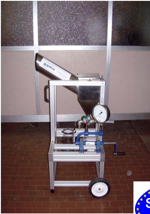
Fig. 21 – Banco prova per la determinazione della portata delle lance, dotato di banco prova manometri montato sulla struttura dell’attrezzatura, (foto G. Oggero – DEIAFA)
