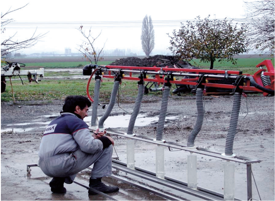
Fig. 15 – Verifica della port: a barra irroratrice (foto CRPV)
