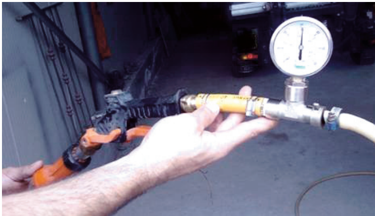
Fig. 22 – Determinazione della pressione in prossimità della lancia (foto G. Oggero – DEIAFA).
