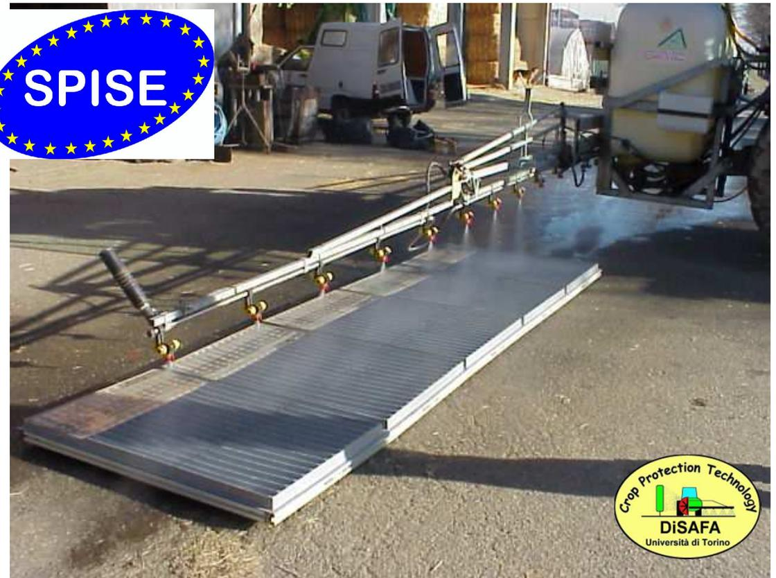
Banco semplificato smontabile e trasportabile per il rilievo del diagramma direttamente in azienda
