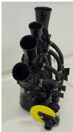
La corrente d'aria a forte velocità prodotta da un ventilatore c
