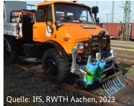
Messung von Schallemissionen dB(A) in 5 m Entfernung von der Seite in 1,5 m Höhe, Mittelwert über 2 Sekunden
